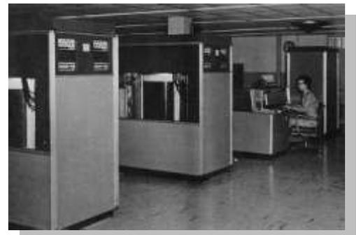
Die Lese-/Schreibköpfe wurden elektronisch-pneumatisch gesteuert, was einen Druckluft-Kompressor benötigte. Die nur vermietbare Festplatte wog 500 kg, verbrauchte 10 kW Energie und benötigte einen Raum von 1,52 m Länge, 1,72 m Höhe und 74 cm Breite.
