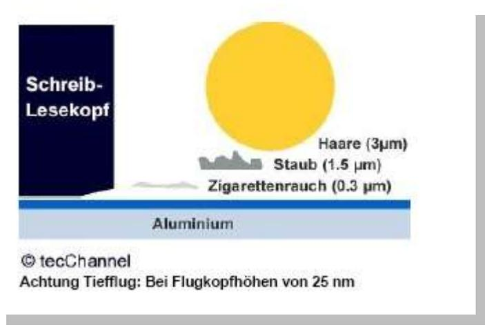
staubfreien Raum zerstört ist. Festplatten werden in speziellen Reinräumen, bei denen Staub unter Hochdruck abgesaugt wird, hergestellt und repariert. Das Festplattengehäuse ist sehr stabil und hermetisch abgeschlossen. Luft kann durch Druck- oder Temperaturänderungen in das Festplattengehäuse gefiltert durch ein kleines Loch eindringen.
